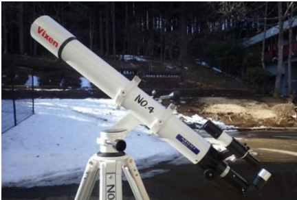
Vixen ポルタ II A81M f 口径：80mm 焦点距離：910mm
