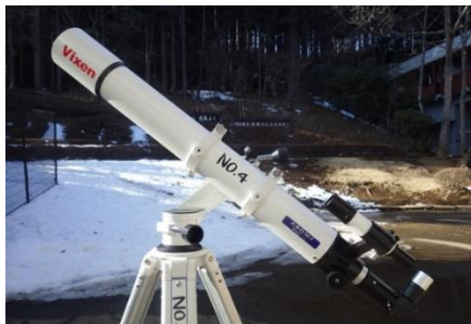
Vixen ポルタ II A81M f 口径：80mm 焦点距離：910mm
